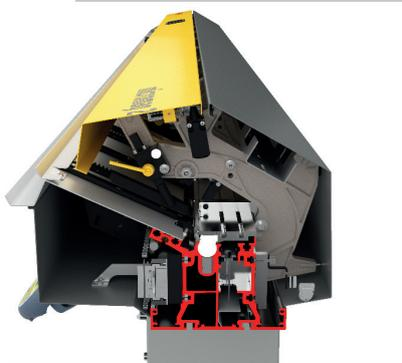
Verwindungssteifer Maschineträger aus gezogenem Aluminium sorgt für optimale Vibrationsdämpfung
