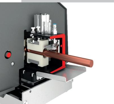
Führungslünette mit austauschbaren Materialführungen für die Verarbeitung von Rund, Vierkant- und Sechskantstangen
