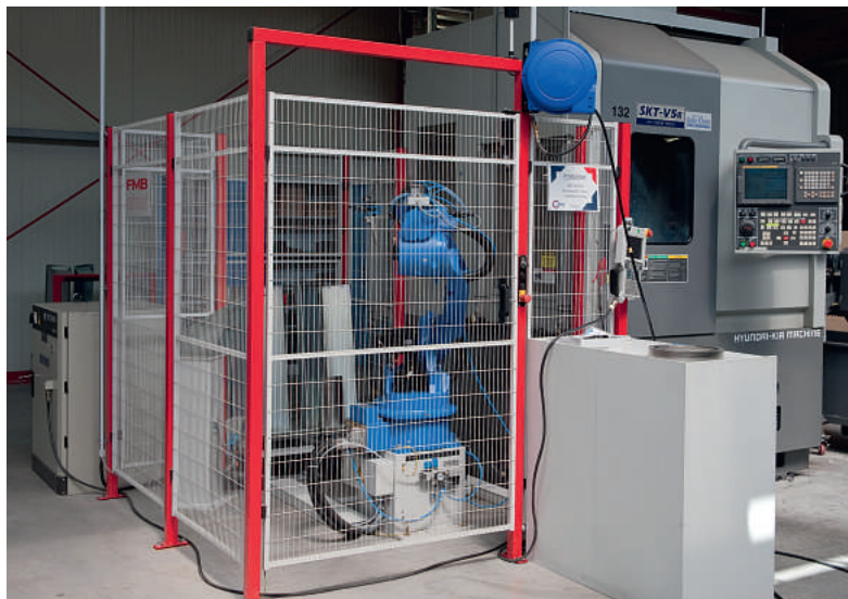
Die mit dem Robotersystem Unirobot von FMB ausgestattete Drehzelle ist für die bedienerlose Komplettbearbeitung von Metaldichtungen mit Dicken von 3 und 4 mm sowie Durchmessern von 70 bis 450 mm ausgelegt.
