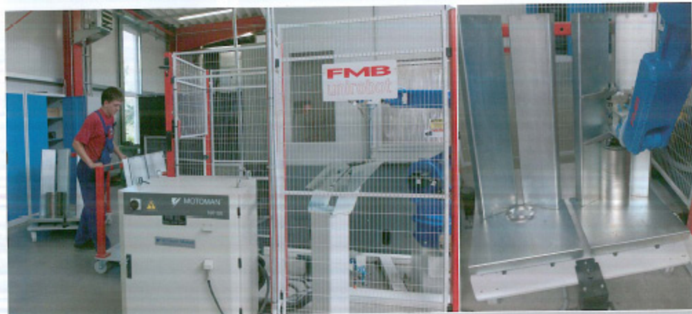
Bild 9a und 9b: Einfach, schnell, prozessparallel: Die beiden Rollwagen bieten Stapelflächen für bis zu 300 Roh- und Fertigteile. Die simplen „Materialsponder“ sind in 2 Minuten ausgetauscht. Die Drehbearbeitung einer Kammdichtung dauert bis zu 6 Minuten
