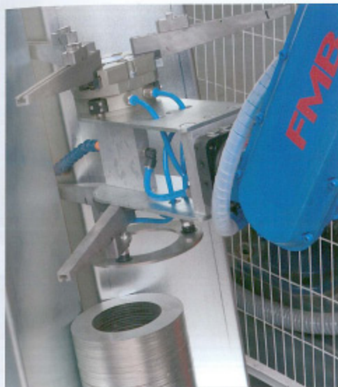
Bild 6: Erfahrung macht klug: Die Rohlinge sind lasergeschnitten. Damit der Wechselgreifer alle Dichtungsringgrößen prozesssicher hält, erledigen drei Saugnapfe die Erstaufnahme. Nach der Drehoperation 1. Seite sind auch die Ringinnenflächen glatt und mit einem Dreibacken-Innenspanner sicher zu greifen
