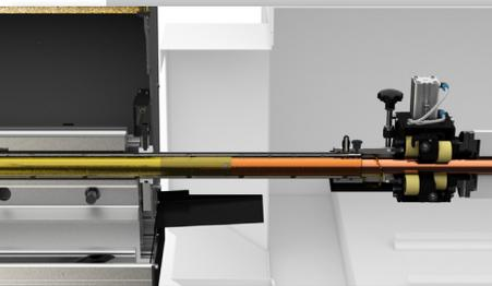
Der durchgängig ölgeflutete Führungskanal garantiert höchste Führungseigenschaften übergangslos bis zur Spindel.
