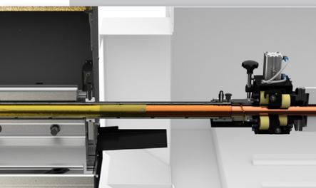
Der durchgängig ölgeflutete Führungskanal garantiert höchste Führungseigenschaften übergangslos bis zur Spindel.
